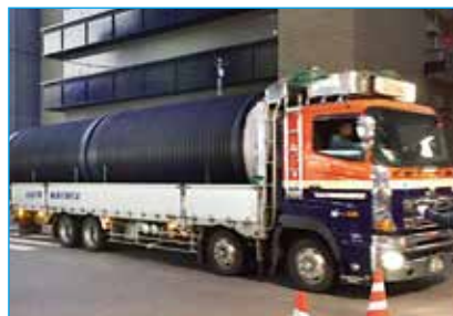
ハウエル管納入状況
