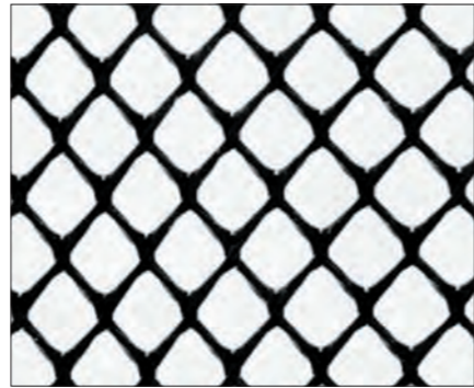
呼称 WF4 網目の大きさ(ピッチ) : a8mm x b8mm サイズ(幅 x 長さ) : 124cmx30m 色 : 黒 | 主材料 : 高密度ポリエチレン
