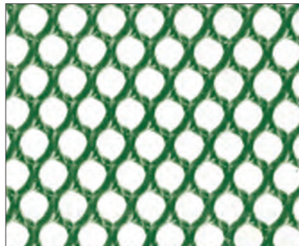
呼称 AN3 網目の大きさ(ピッチ) : a5mm x b5mm サイズ(幅 x 長さ) : 30cmx30m, 40cmx30m, 62cmx30m, 124cmx30m 色 : 濃緑 | 主材料 : 高密度ポリエチレン
