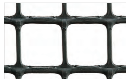
呼称 N-955 網目の大きさ(ピッチ) : W20mm x L21mm サイズ(幅 x 長さ) : 200cm x 50m 色 : 黒 主材料 : 高密度ポリエチレン
