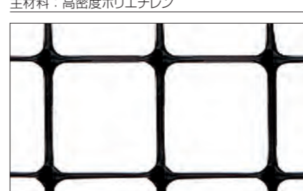
呼称 MS-3 網目の大きさ(ピッチ) : W20mm x L21mm サイズ(幅 x 長さ) : 100cm x 100m, 150cm x 100m, 200cm x 50m 色 : 黒 主材料 : ポリプロピレン
