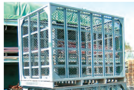
コンテナの内張 落下を防止し、緩衝材の役割を果たす
