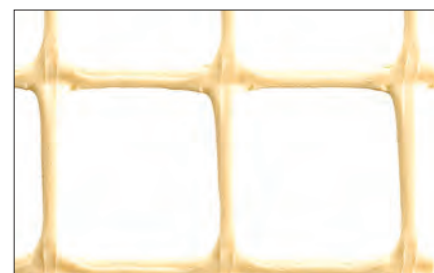
呼称 N-28 網目の大きさ(ピッチ) : W25mm x L25mm サイズ(幅 x 長さ) : 100cm x 50m 色 : アイボリー / 白 主材料 : 高密度ポリエチレン
