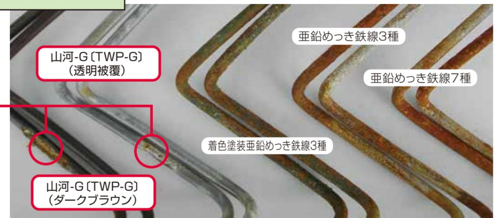
海岸沿い設置4年でこれだけの差がでます → 塩害での圧倒的な耐久性
